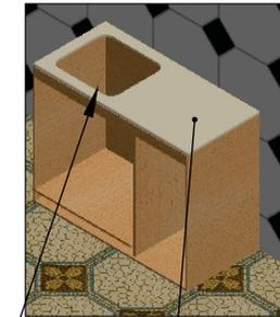
**4-** Coloque la lámina de cartón sobre el tope o mesón que cubrirá la base de apoyo y trace el contorno de la lámina.
