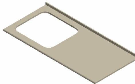
**6-** Coloque el lavaplatos sobre la base de apoyo, aplique el adhesivo sellador de su preferencia sobre la pestaña de la poceta, posteriormente coloque el mesón encima y ajústelo hasta que no se vea la base de apoyo.
