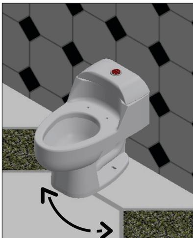
**7-** Instale el conector al suministro de agua y al sanitario, compruebe si hay fugas usando varias descargas.
