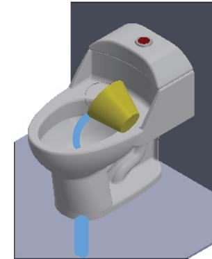
**3-** Verificar que la distancia de la pared terminada hasta el centro del desagüe sea de 305 mm.
