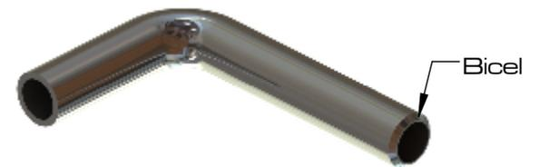
**Nota:** se recomienda bicelar el tubo y aplicar un agente lubricante para evitar rasgar el empaque adaptador, y mejorar la manipulación durante la instalación del sanitario.
