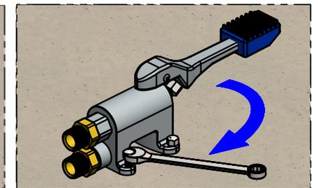
**5-** El conector de salida es la manguera larga, identifíquela y proceda con la conexión del conector a la salida de agua de la válvula.
