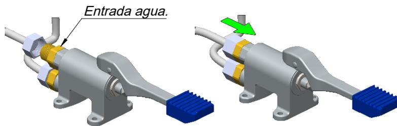
**7-** El otro extremo del conector de entrada de agua debe conectarse a la llave regulación.
