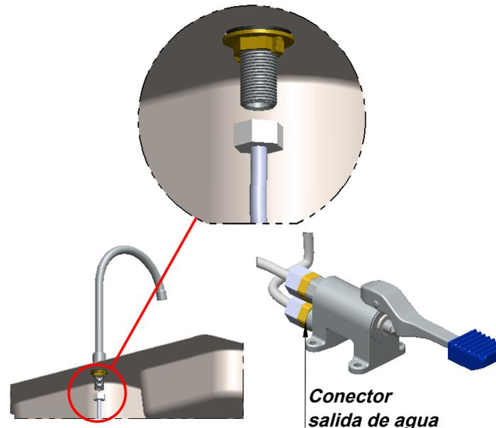
**10-** Abra el paso de agua de la red y realice la prueba de flujo verificando que el funcionamiento de la válvula y brazo no presente novedades, también revise que las conexiones no presenten fugas. Con la llave de regulación gradúe el caudal de acuerdo al uso.
