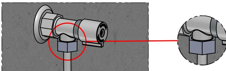
**8-** Inserte el empaque y el brazo a través del mesón o lámina inoxidable y fije la base del brazo por debajo con la tuerca.
