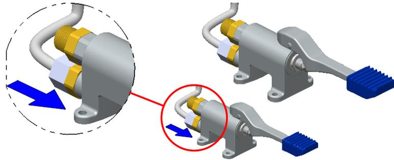
**6-** El conector de entrada es la manguera corta, identifíquela y proceda con la conexión del conector a la entrada de agua de la válvula.
