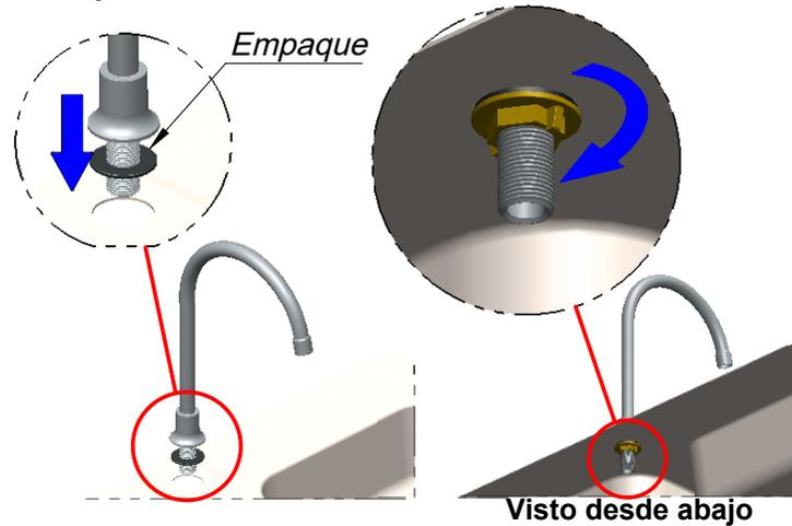
**9-** Retome el conector de salida que ya conectó en la válvula y con el otro extremo realice la conexión al cuerpo del brazo ya instalado.
