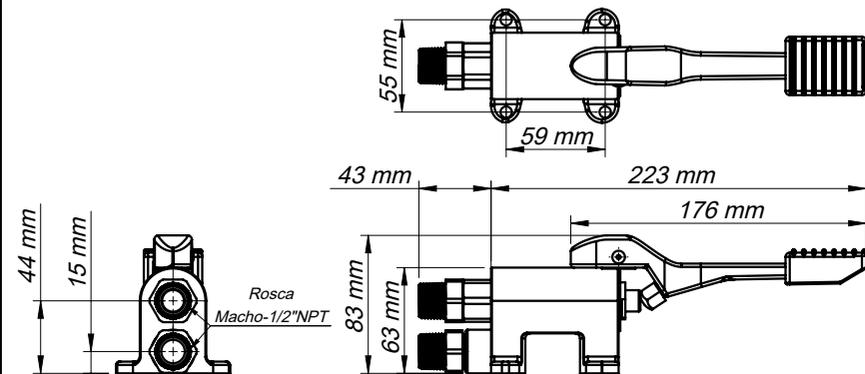
**3- Marque en el piso los agujeros de perforación y perforo con el taladro. Use broca para muro de Ø5/16\"**
