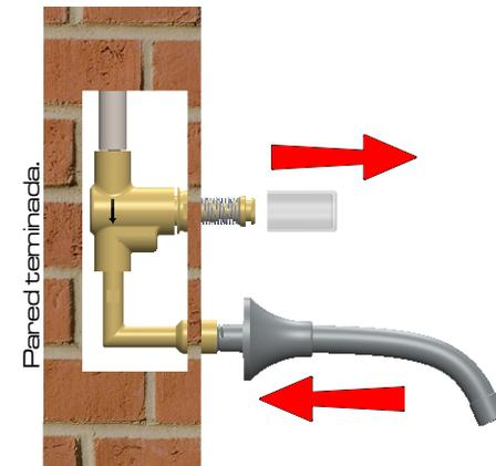
**NOTA:** En caso de descalibración, utilice la llave de calibración gricol con giro en sentido horario para el aumento del caudal de la válvula, (flecha verde). Para reducción invierta el sentido de giro con la llave, (flecha roja), hasta lograr el consumo deseado.
