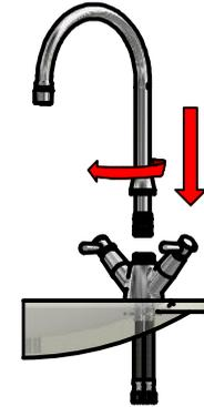
**4-** Realice la conexión con los conectores de la acometida hidráulica de pared. (Agua fría y caliente)
