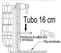
Para regaderas BL-3730-11 Y BL-3330-11, coloque el empaque entre la extensión y la unión para evitar posibles fugas y utilice teflón en la unión.
