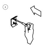
Fije la pieza en la pared con los tornillos
