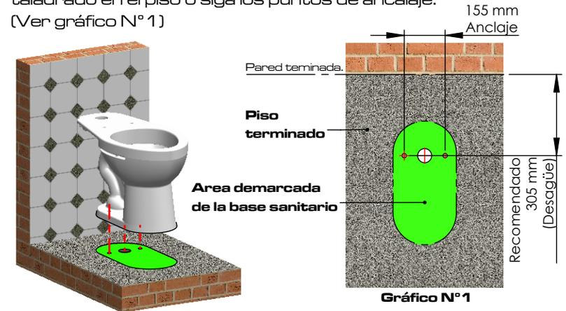
Verifique que los centros de anclaje y desagüe deben corresponder entre el piso terminado y la taza. Se recomienda realizar instalación con brida sanitaria.
