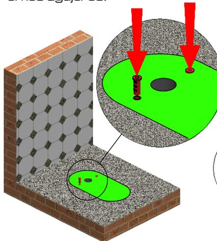
3. Asegure el anclaje de la taza roscando los tornillos y colocando los protectores.
