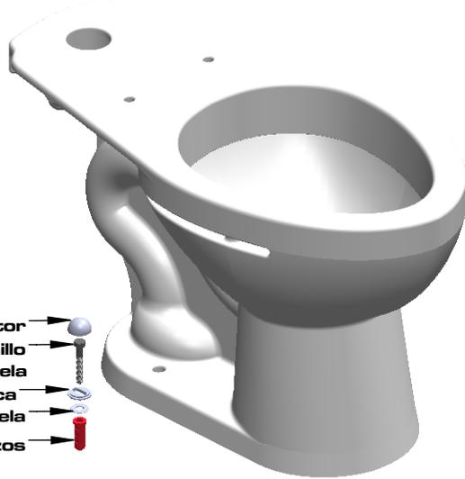
° Antes de instalar el sanitario se recomienda hacer una prueba de flujo a la acometida hidráulica, dando paso de 2 litros de agua aproximadamente en un recipiente, para evitar que sedimentos de la obra ó de otro tipo se depositen en los sistemas de paso hidráulico y afecten el óptimo funcionamiento del sistema sanitario.
