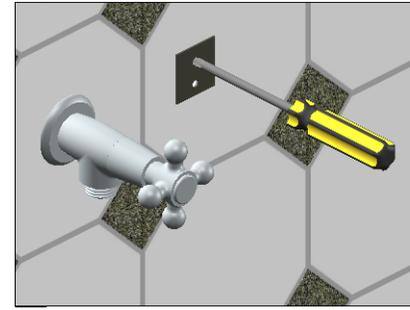
5. Ajuste el soporte deslizando en la placa.
