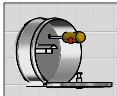
**5** - Utilice la llave para asegurar la compuerta de dispensador.
