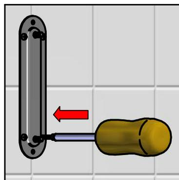
**6-** Realice ensamble de la base espejo con la lámina de anclaje y rosque la tuerca sierra.
