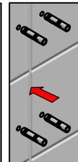
**5-** Ajuste la lámina de anclaje colocando los tornillos.
