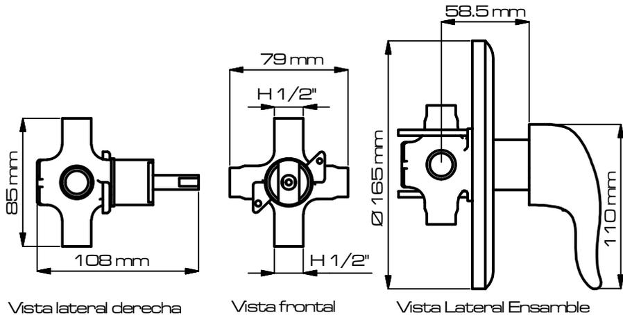
**1-** Ubique el cuerpo de la válvula con el aviso UP en la parte superior.
