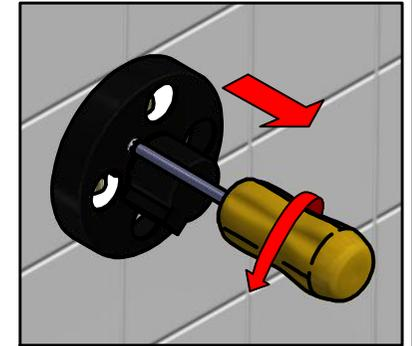
**4-** Deslice el escudo y ajuste con los tornillos.
