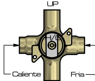
**2-** Realice la conexión de la tubería de la válvula.
