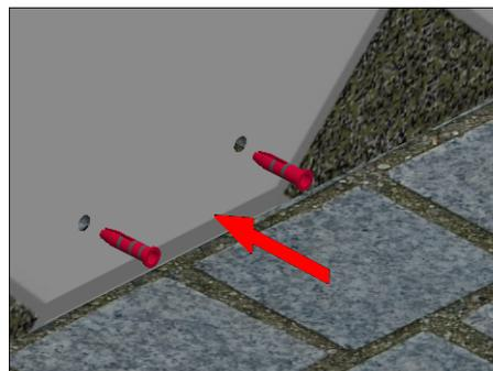
2. Ajuste el cuerpo atornillando en los chazos instalados
