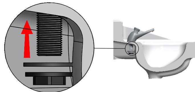
3. Realice la conexión roscando el conector en la grifería.
