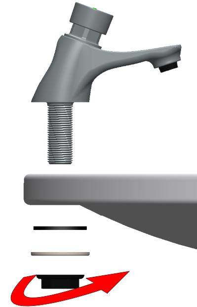
3. Realice la conexión con la tubería.
