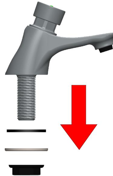
2. Coloque la grifería en el lavamanos y por abajo coloque el empaque, luego la arandela y rosque la tuerca hasta fijar la llave.
