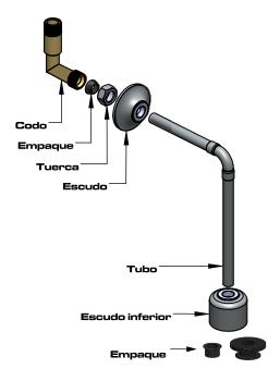
Preinstale el codo a la válvula o fluxómetro (empotre conjunto).
