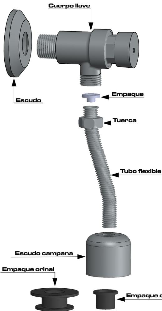
1. Verifique que la terminal en el muro sea hembra de 1/2" NPT, rosque el cuerpo llave junto con el escudo, en la terminal hembra de la pared.
