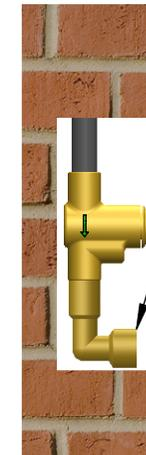
2. Instale la válvula, roscando en la acometida hidráulica.
