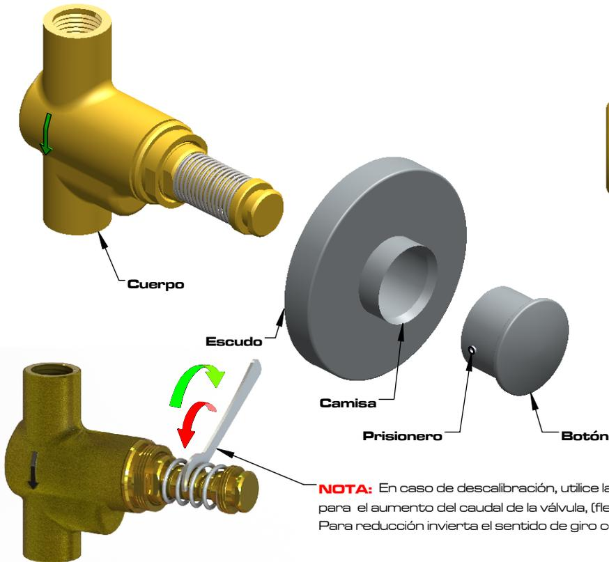
**NOTA:** En caso de descalibración, utilice la llave de calibración gricol con giro en sentido horario para el aumento del caudal de la válvula, (flecha verde) Para reducción invierta el sentido de giro con la llave, (flecha roja), hasta lograr el consumo deseado.
