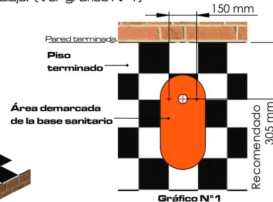
Verifique que los centros de anclaje y desagüe deben corresponder entre el piso terminado y la taza. Se recomienda realizar la instalación con brida sanitaria.
