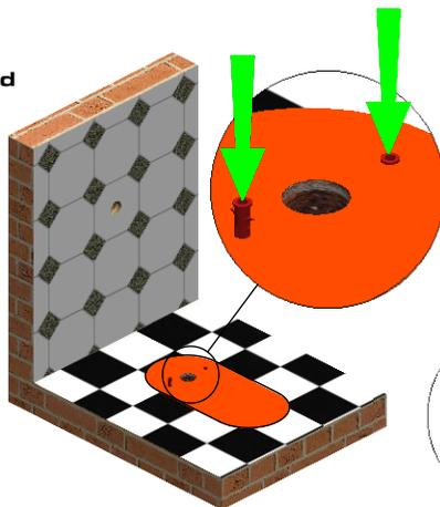
1. Ubique el inodoro en la posición esperada siguiendo las medidas recomendadas para demarcar los puntos de taladrado en el piso ó siga los puntos de anclaje. (Ver gráfico N° 1)
