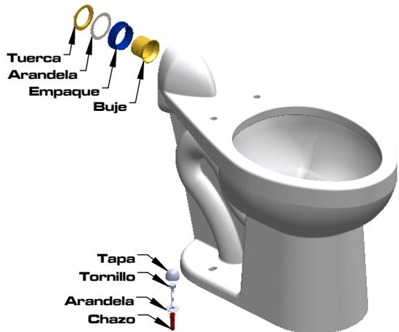
Antes de instalar el sanitario se recomienda hacer una prueba de flujo a la acometida hidráulica, dando paso de 2 litros de agua aproximadamente en un recipiente, para evitar que sedimentos de la obra ó de otro tipo se depositen en los sistemas de paso hidráulico y afecten el óptimo funcionamiento del sistema sanitario.
