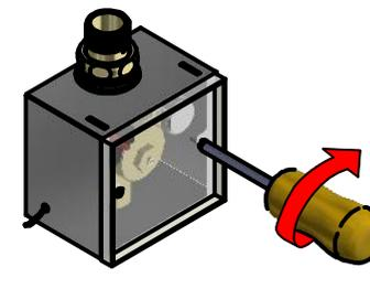
**3-** Realice la instalación de la acometida y empalme los cables de alimentación sin conectar a la corriente eléctrica.
