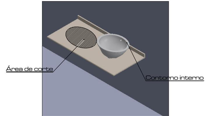
**5-** Coloque el lavamanos sobre la base de apoyo, aplique el adhesivo sellador de su preferencia sobre la pestaña del lavamanos, posteriormente coloque el mesón encima y ajústelo hasta que no se vea la base de apoyo.
