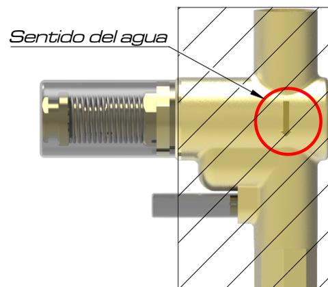
**2.** Instale la válvula roscándola a la acometida hidráulica y empotrándola a la pared.
