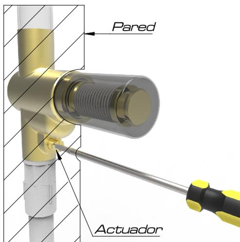
**4.** Retire el protector plástico y rosque el buje en el cartucho con el escudo montado, una vez rosado deslice el escudo hasta la pared terminada y rosque el botón.
