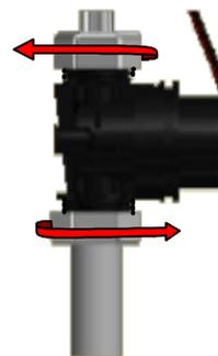
**2-** Coloque la grifería cuidadosamente sobre el lavamanos y por debajo agregue en la grifería el empaque, la arandela y rosque la tuerca hasta ajustar la llave.
