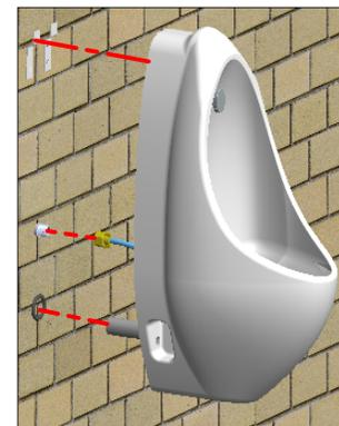
2. Soportes: Marque los agujeros y realice las perforaciones para los chazos. Inserte los chazos en la pared y asegure los soportes para el orinal.
