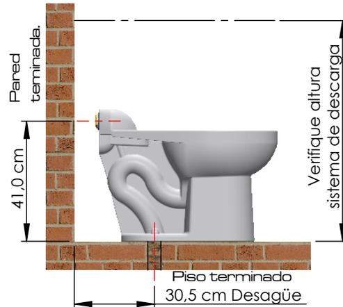
1. Ubique el inodoro en la posición esperada siguiendo las medidas recomendadas para demarcar los puntos de taladrado en el piso o siga los puntos de anclaje. (Ver gráfico N° 1)
